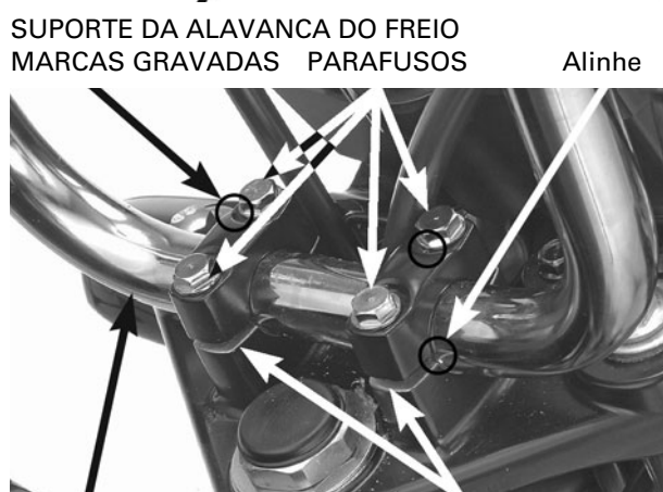
GUIDÃO PARAFUSO DO SUPORTE FIXADORES DO GUIDÃO
