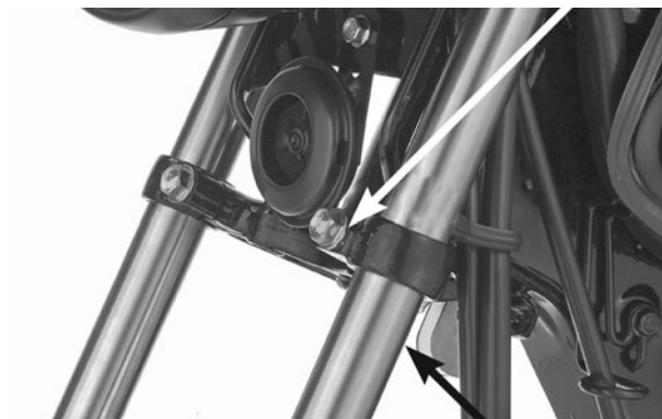
GARFO DA SUSPENSÃO PARAFUSO SUPERIOR/ANEL DE VEDAÇÃO
